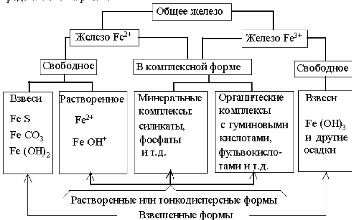
Рис. 1.2. Схемы существования различных форм железа в воде
